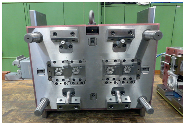
Bild 5. 4-fach-Werkzeug (Auswerferseite) für einen Stator, das auf einer Rundtischmaschine läuft. Darin enthalten ist ein CVe-Monitor zur elektronischen Werkzeugüberwachung, der auf dem Display Schusszahl, Zykluszeit und Auslastung anzeigt © Mühlbeyer
