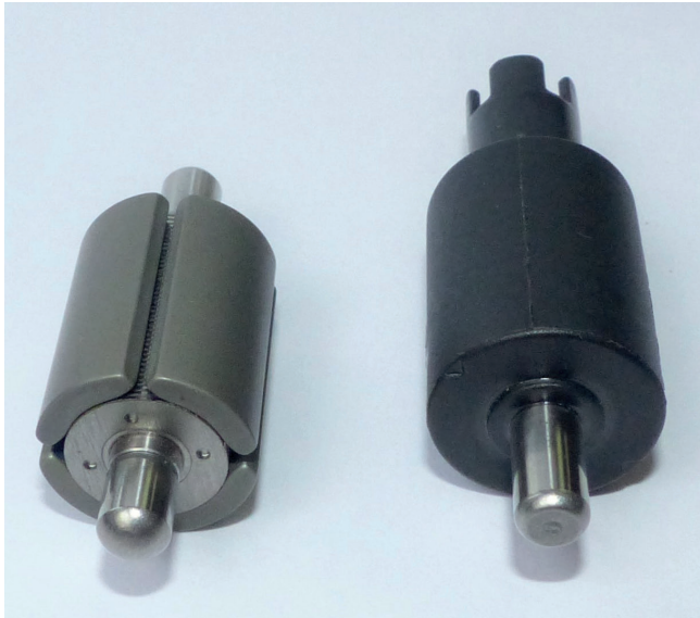
Bild 1. Beispiele für kunststoffummantelte Rotoren © Mühlbeyer
