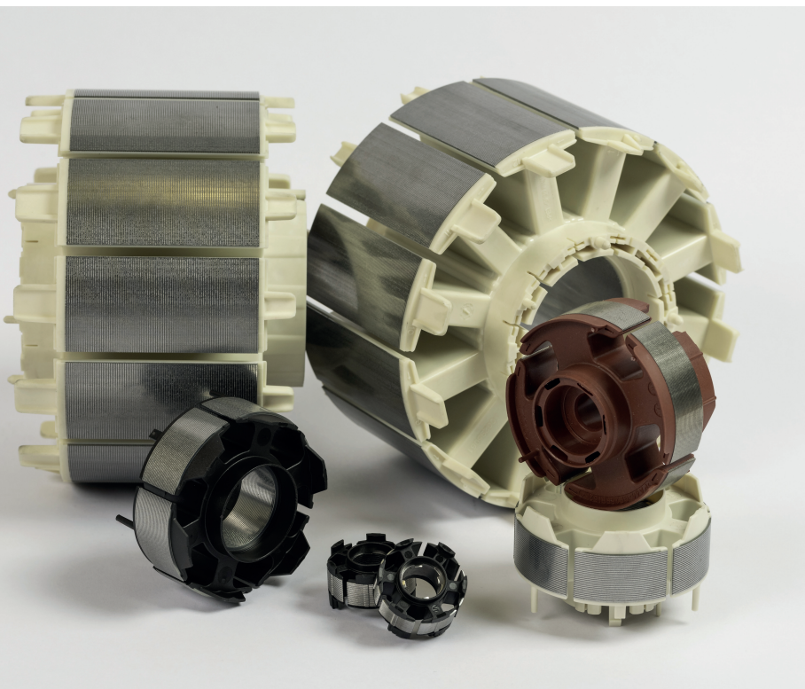
Verschiedene kunststoffummantelte Statorn. Beim Umspritzen der Stanzkomponenten können neben der Isolierung auch technische Funktionen in das Bauteil eingebracht werden © Mühlbeyer
